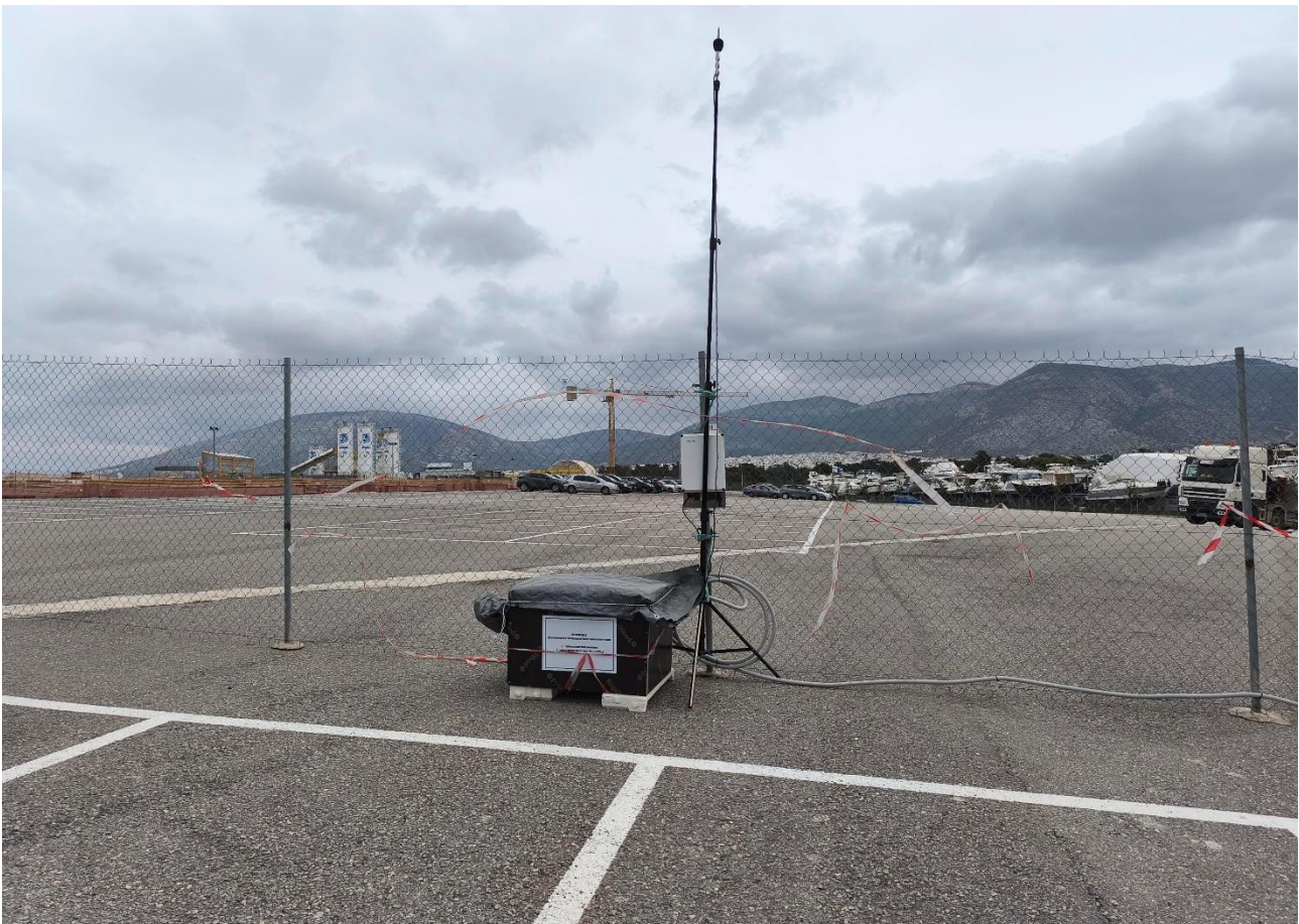
Σχήμα 2.1-2: Σταθμός περιβαλλοντικής παρακολούθησης τοποθετημένος σε κατάλληλη θέση
