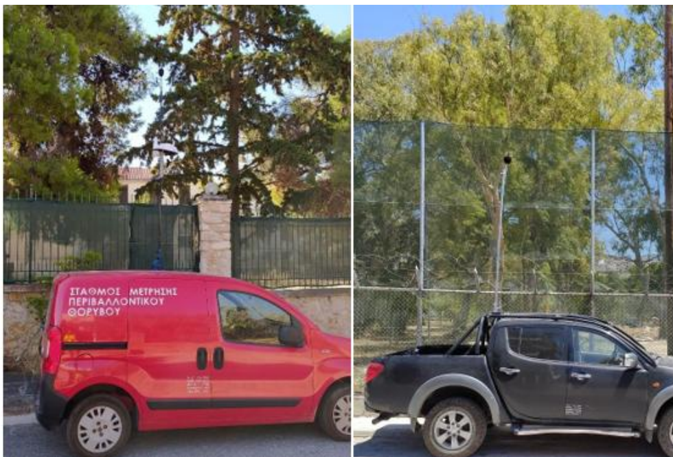
Σχήμα 2.1-2: Σταθμός παρακολούθησης θορύβου τοποθετημένος σε κατάλληλα οχήματα
