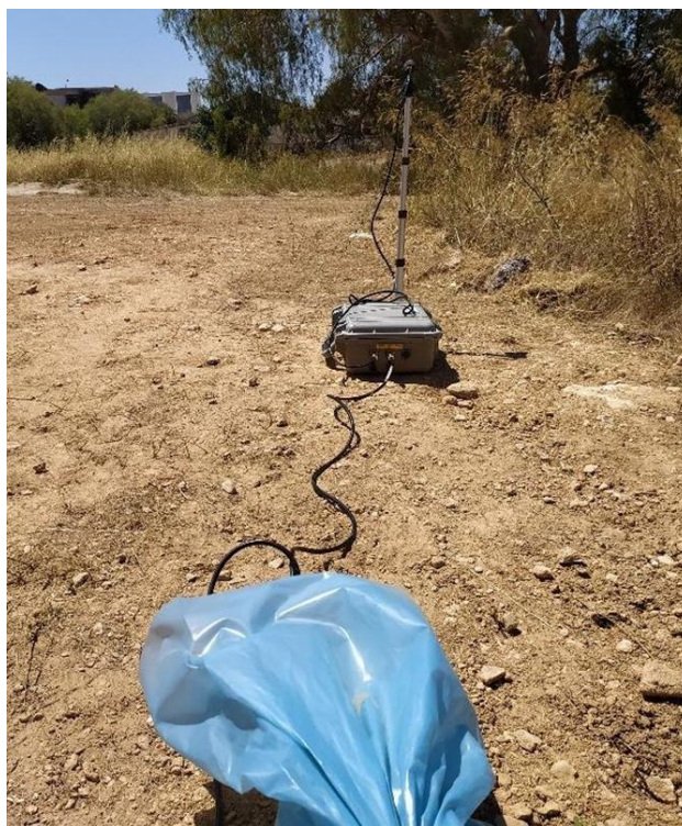
Σχήμα 2.3-4: Σταθμός μέτρησης παρακολούθησης δονήσεων
