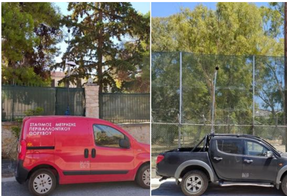
Σχήμα 2.1-2: Σταθμός παρακολούθησης θορύβου τοποθετημένος σε κατάλληλα οχήματα
